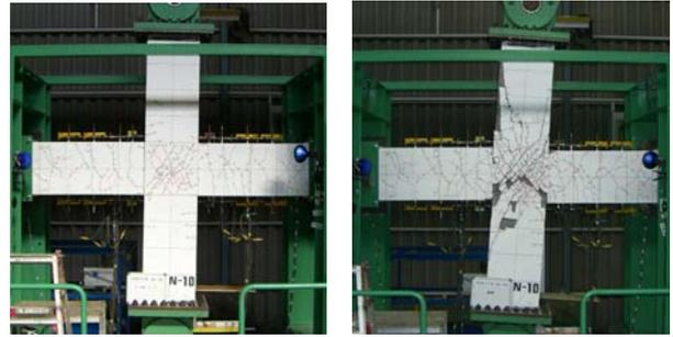
N-10 試験体 最大耐力時( $R=1/50$ ) 最大変形時( $R=1/17$ )
