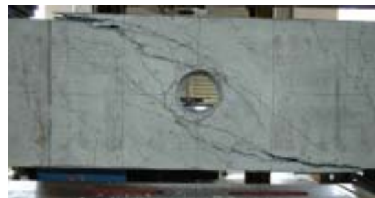
写真-2 最終破壊状況 (27-DS31)
