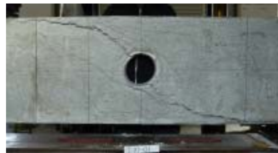
写真-1 最終破壊状況 (27-01)
