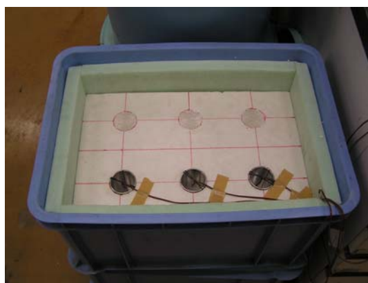
写真－１ 簡易断熱温度測定試験
