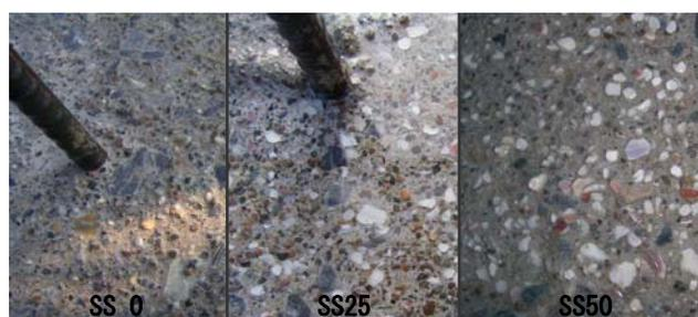
写真-3 レイタンス処理後の打継ぎ部
