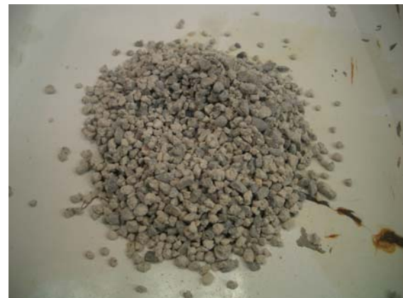
図-9 破碎モルタル片
