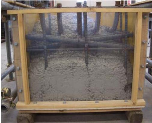
写真-2 モデル型枠内のかぶり部分の充てん状況
