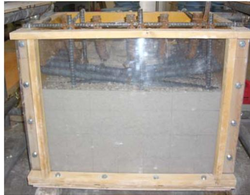
写真-3 モデル型枠内のかぶり部分の充てん状況
