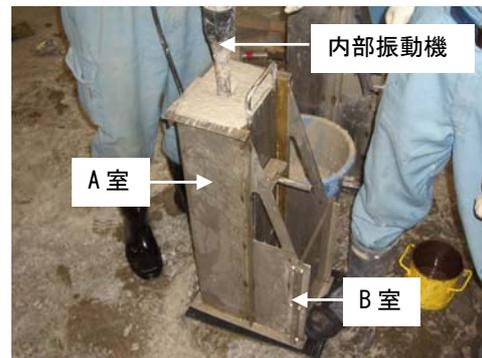
写真-1 振動機を挿入した間隙通過試験状況
