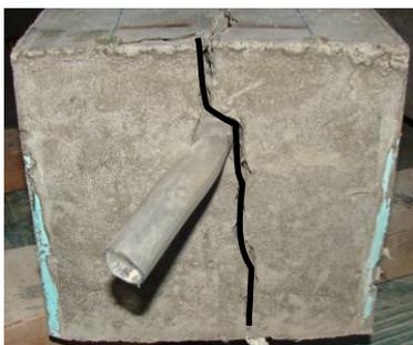
図-10 供試体端部の割裂状況
