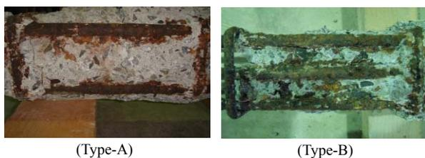
写真-3 引張鉄筋付近の状況
