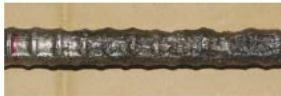
写真 - 1 供試体内部鉄筋例 (除錆後)
