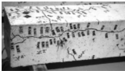
写真 - 1 供試体のひび割れ状況 (写真は供試体 A2)
