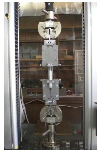
図-2 ダンベル型供試体試験状況
