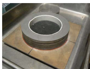
写真-1 供試体下部の空間
