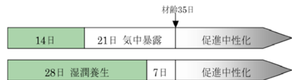
図-12 促進中性化試験における養生条件
