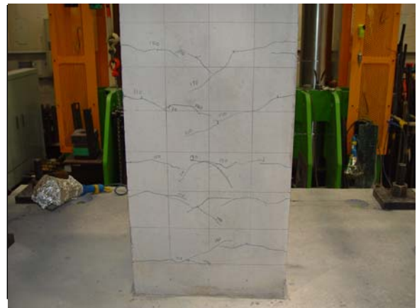
写真－1 1\delta_y 載荷時点の損傷状況
