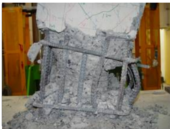
写真－４ 28 \delta_y 載荷時点の損傷状況
