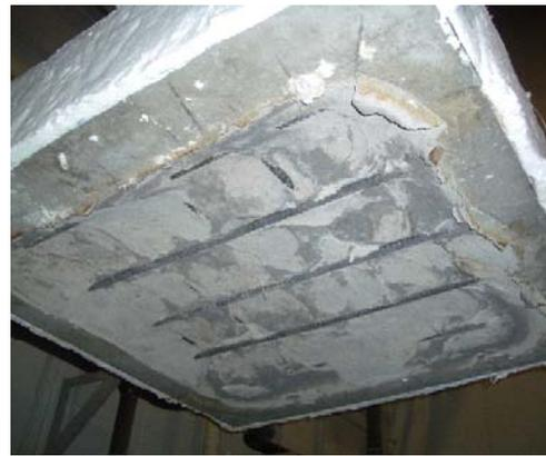
写真-1 耐火試験後状況 (P-00F)
