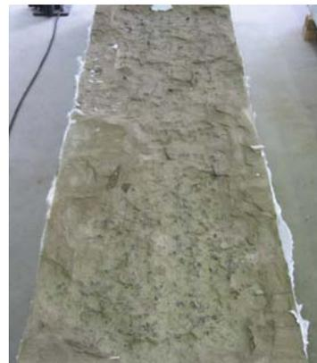
写真-2 耐火試験後状況 (P-05F)
