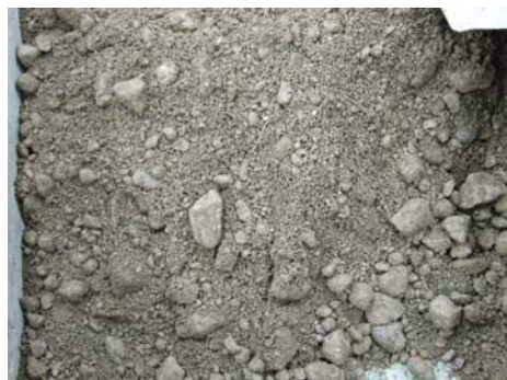
写真－1 解体コンクリート塊の外観
