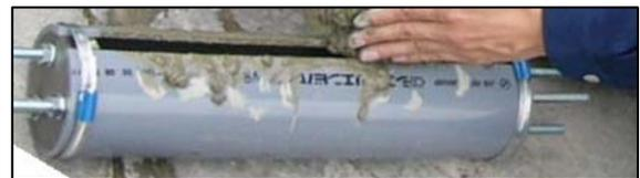
写真-1 直接引張試験供試体の型枠
