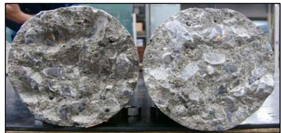
写真-2 直接引張試験供試体の破断面
