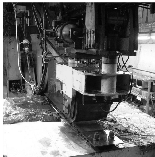
写真-1 クランク（鉄輪）式輪荷重走行試験機
