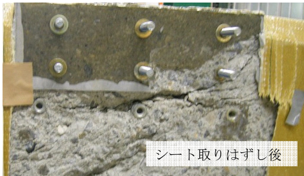
写真-1 A-3 供試体のひび割れ状況
