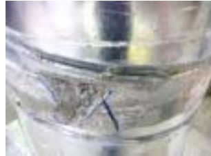
CR4-2 スポット溶接破断
