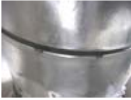
CR2-1 スポット溶接破断
