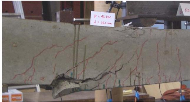
図-9 試験体 No. 4 の最終破壊モード
