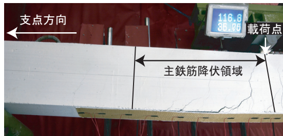
(a) N 試験体 (実測最大荷重時近傍)
