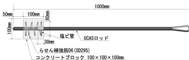
図 - 5 ロッド母材の付着試験試験体
