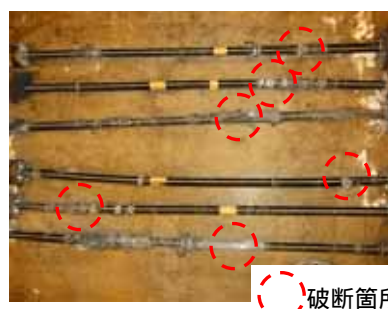
写真 - 1 破断状況（ロッド母材の引張試験）
