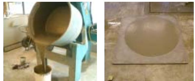
図－２ HPFRC の練上り性状
