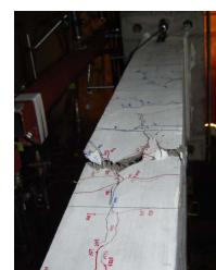
No. 5 PVA1.00-0.24-S 上面割裂ひび割れなし
