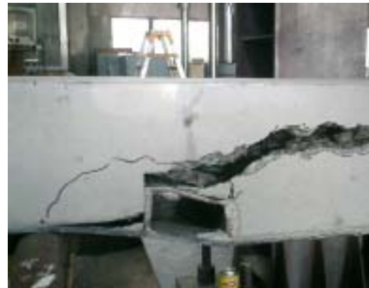
写真－２ 溝形鋼の終局状態 (試験体 B-2)
