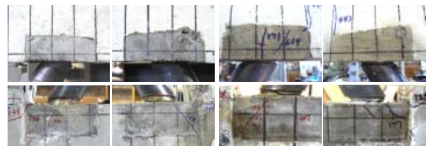
写真 - 3 実験終了後のブレース接合部状況
