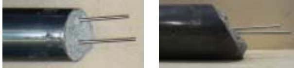
(b) 引張抵抗した側の左ブレース 写真 - 7 プレースの基礎梁側の丸鋼の軸
