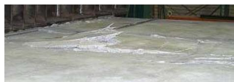
写真-1 No.3 スラブ上面（左側）の破壊状況
