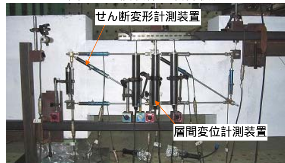
図 - 3 荷重時における変位の計測状況
