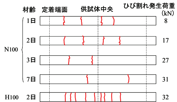
図－5 貫通ひび割れ発生位置・荷重
