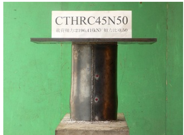
写真-1 試験体の終局状況例
