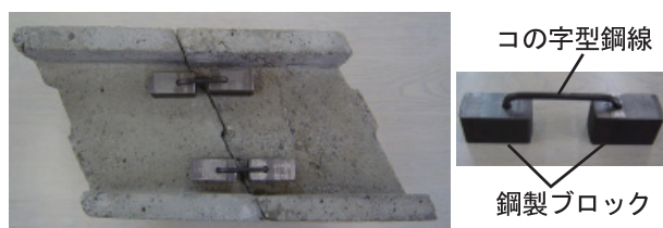
写真－２ 連結金具と連結方法例（試験体No.3）
