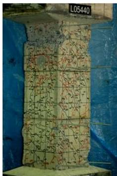
写真-1 最終破壊状況
