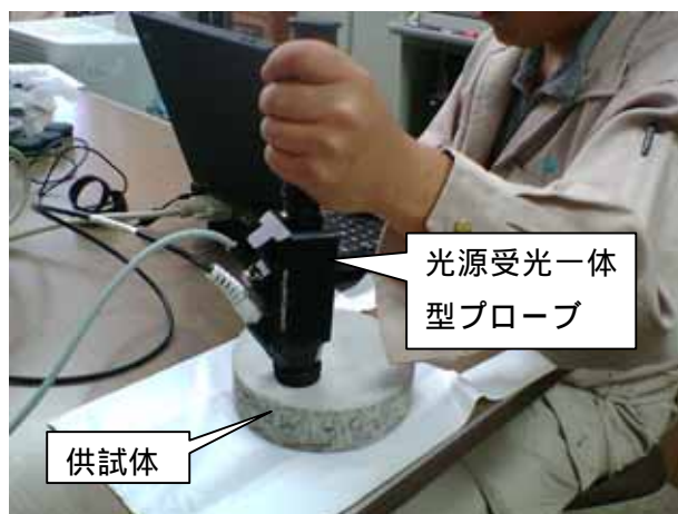
写真 - 2 表面測定状況
