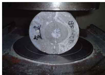
写真 - 2 注入後の割裂模様
