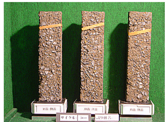
写真－５ 含浸材 D (300 サイクル終了時) 状況
