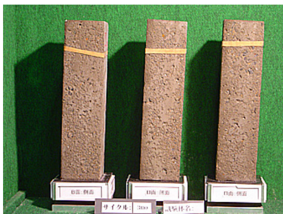
写真－３ 含浸材 B (300 サイクル終了時) 状況
