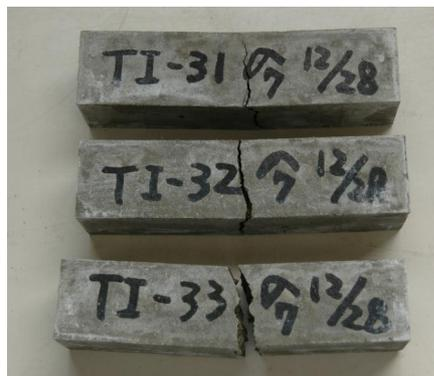
写真-6 曲げ試験後の試験体の破壊性状 (No. 11—木材繊維30%混入)
