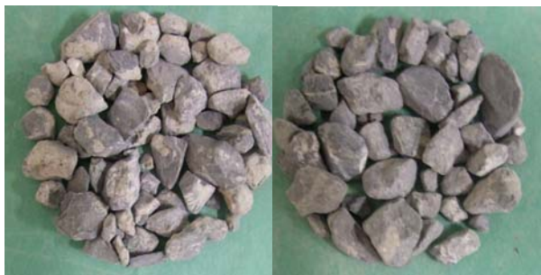
写真-2 Fの再生粗骨材の外観 (左：10分すりもみ，右：30分すりもみ)
