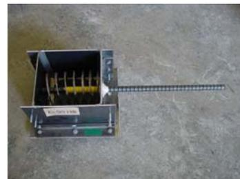
写真-1 付着試験体型枠
