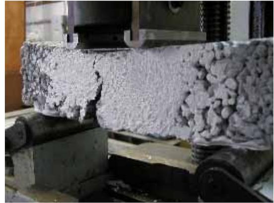
写真 - 4 beam-2 の破壊状況
