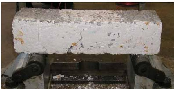
(a) 落下距離 40cm での損傷状況
