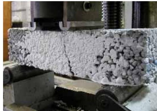
写真 - 5 beam-3 の破壊状況
