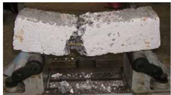
(b) 落下距離 90cm での破壊状況
