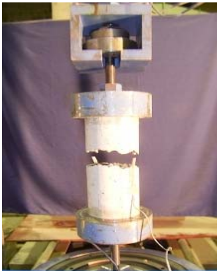
図－2 直接引張試験 全景
