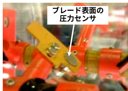
写真-2 圧力センサの取付け位置
