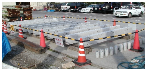
写真－１ 屋外暴露の状況
