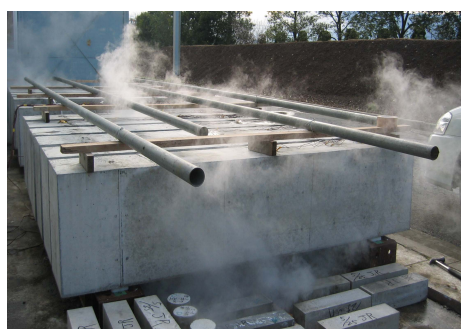
写真－１ 促進養生状況（シートを外した状態）
