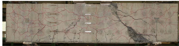
写真－3 No.2 試験体破壊状況
