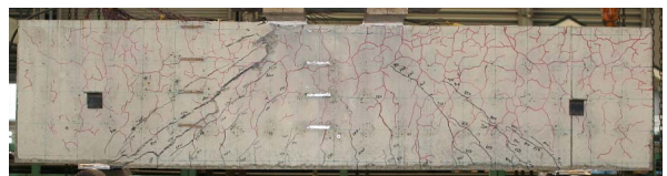
写真－4 No.3 試験体破壊状況
