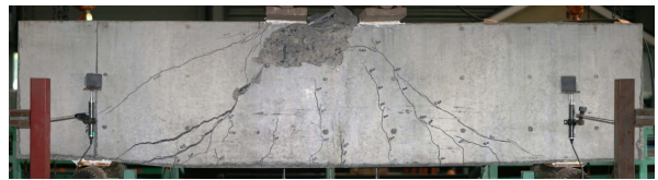
写真－2 No.1 試験体破壊状況
