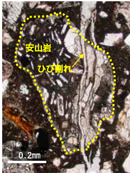
写真 - 3 細骨材周囲のひび割れ状況(単二コル)
