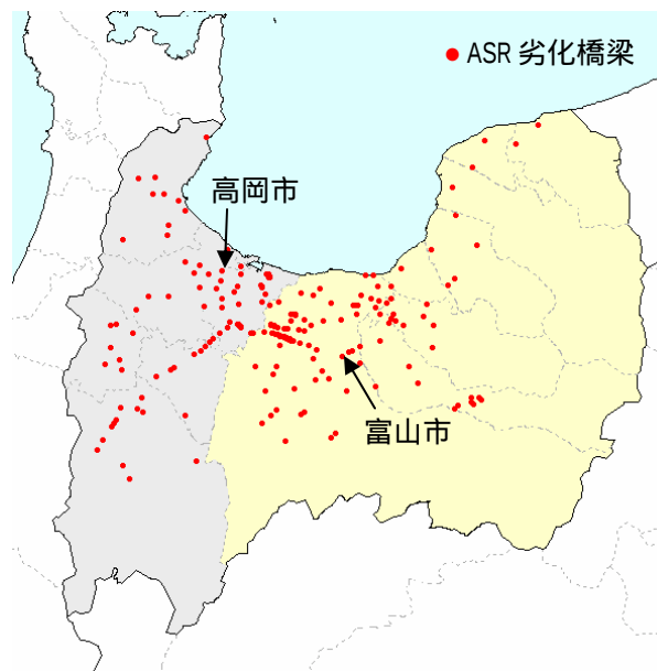
図 - 1 富山県内の ASR 劣化橋梁分布状況
