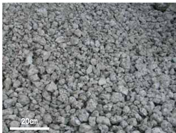
写真 - 2 碎石状に破砕されたコンクリート殻
