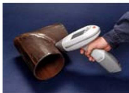
写真-3 エネルギー分散型(可搬型)の例
