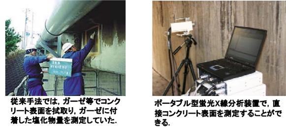
従来手法では、ガーゼ等でコンクリート表面を拭取り、ガーゼに付着した塩化物量を測定していた。
