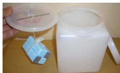
図-2 供試体の溶液浸漬方法
