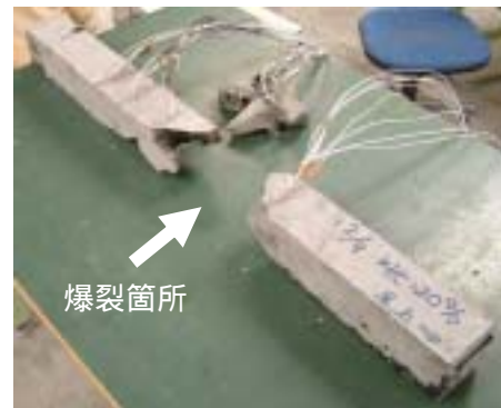
写真-2 加熱後の爆裂状況
