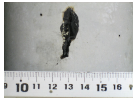
図-5 供試体への影響の様子 (プラスチック片による)
