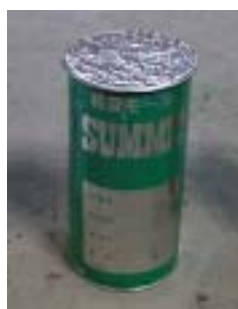
(i) ブリキ製型枠
