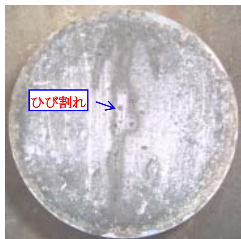
写真－３ VU 管を装着した供試体の割裂引張破壊状況
